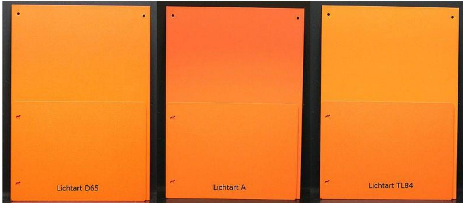
Mit zwei metameren (bedingt gleichen) Farben lackierte Blechhälften zeigen einen gleichen Farbeindruck unter tageslichtähnlicher [Lichtart](#) D65 (links); unter Lichtart A (Mitte) erscheint die obere Blechhälfte rötlicher, unter Lichtart TL84 (rechts) ist dies die untere Blechhälfte
