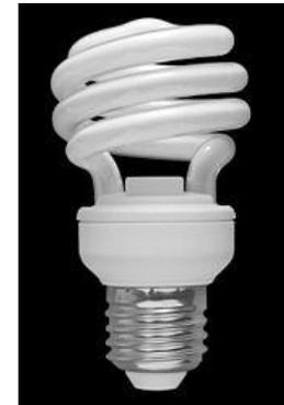
Alle „Energiesparlampen“ bestehen aus Fassungssockel mit (elektronischem) Vorschaltgerät und Glasrohr mit Quecksilberfüllung und Leuchtschicht. Das Lebensdauerende wird durch die Elektronik-Komponenten und die Glühfäden bestimmt.
